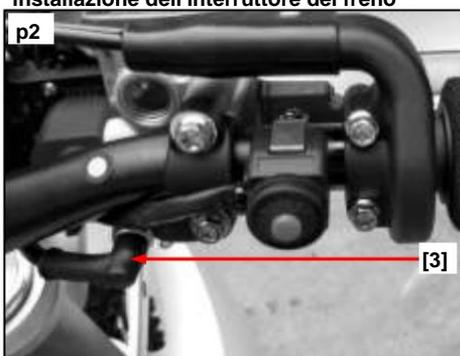
**p2: edizione di fabbrica Posizione di installazione dell'interruttore del freno**
