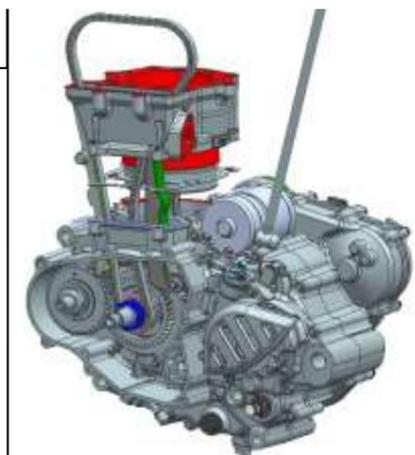
**Nota:** Durante l'installazione del monoblocco, evitare di distruggere le fasce elastiche.
