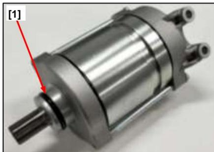
Rimuovere l'o-ring [1]. La sequenza di installazione e rimuovere l'ordine inverso. Nota: la sostituzione di un nuovo o-ring e rivestito con olio motore.
